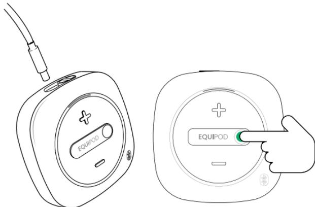
**8a.** Vergewissern Sie sich, dass das Gerät eingeschaltet ist und die Behandlung läuft, indem Sie die EquiPod-App oder die blinkenden LEDs am Gerät überprüfen.
