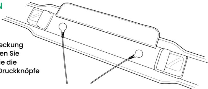
2. Führen Sie das Zubehörkabel zurück in die Gerätetasche und schließen Sie die Klettverschlussabdeckung des Anschlusskabels.
